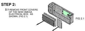
2.2 INSTALL THE NEW OMEGA ELECTRICAL BOX BY ALIGNING IT TO SAME HOLES USED BY THE OLD ELECTRICAL BOX, FASTEN IT USING THE SAME SCREWS. SECURE IT FIRMLY.
